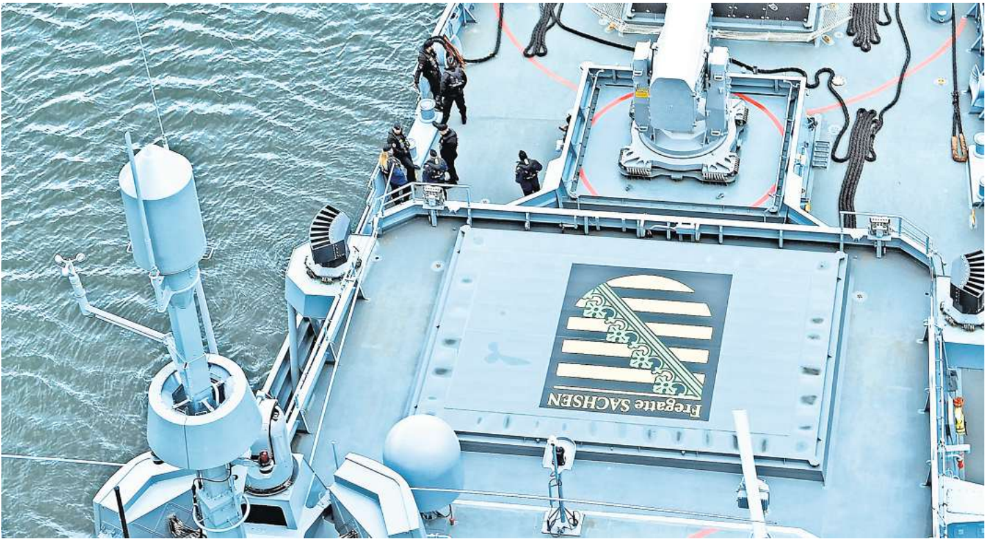
Die Fregatte „Sachsen“ fährt zurzeit ohne Hauptbewaffnung zur See. Dort, wo eigentlich der Starter und die Flugkörper sitzen sollten, liegt nur eine Stahlplatte.
